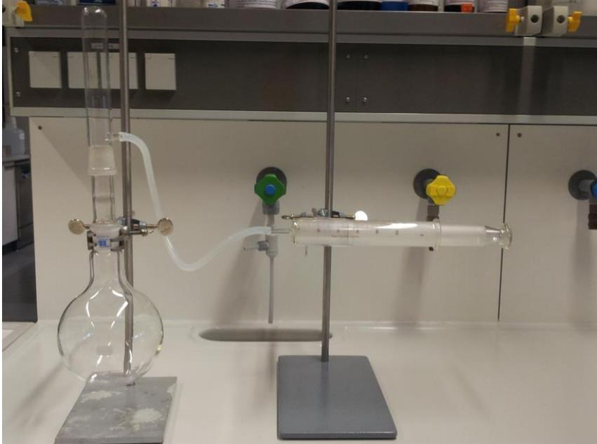
Abbildung 2: Versuchsaufbau nach Hinzugabe des pyrophoren Eisens
