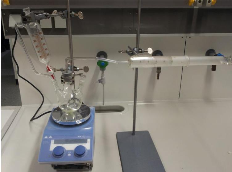
Abbildung 3: Versuchsaufbau zur Sulfitoxidation
