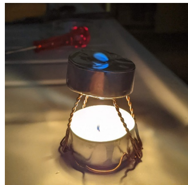
Abbildung 1: Aufbau für die Low-Cost-Variante der trockenen Destillation. Quelle: A. Teplá, 2023
